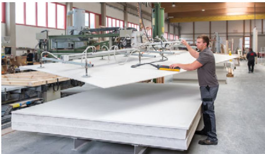
Transport von fermacell® Gipsfaser-Platten mit einem Vakuum-Hebegerät
