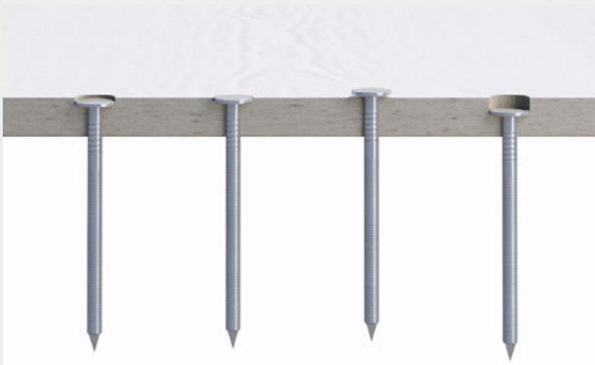
Befestigungsmittel bündig mit Oberfläche oder max. 1mm versenkt eintreiben.
