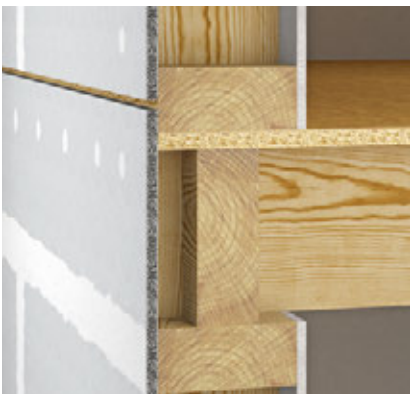
Bild 3: Mit HD-Fugentechnik versehener Bereich des Plattenstreifens
