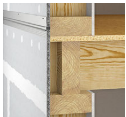
Bild 6: Fertig montierter Plattenstreifen mit fermacell™ Deckenstoßprofil
