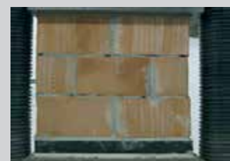
Bild 6: Druckversuch mit Mauerwerkswand aus Hochlochziegeln mit Mauerfußdämmung.
