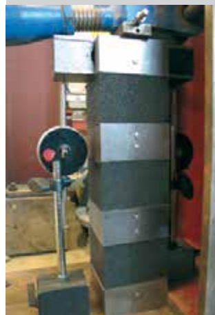
Bild 4: Kriechversuch mit FOAMGLAS® PERINSUL Prüfwürfeln.
