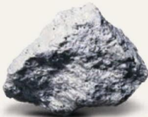
**Der Rohstoff Perlit zeichnet sich bereits seit Jahrzehnten als hervorragender Baustoff in der Anwendung als Ausgleichs- und Dämmstoffschüttung sowie als kapillaraktive und diffusionsoffene Innendämmung aus.**
