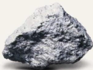
**Der Rohstoff Perlit zeichnet sich bereits seit Jahrzehnten als hervorragender Baustoff in der Anwendung als Ausgleichs- und Dämmstoffschüttung sowie als kapillaraktive und diffusionsoffene Innendämmung aus.**
