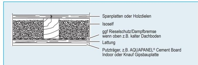
Dämmstoffschüttung auf einer Betondecke
