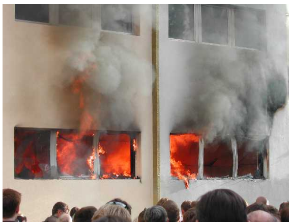
Foto: Fassadenbrandtest (27. Prüfminute)
