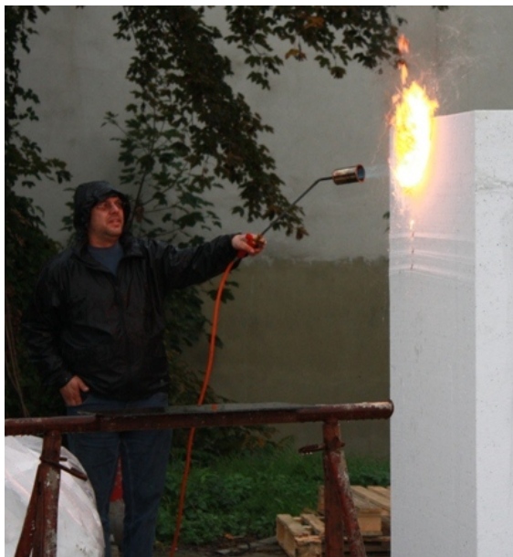
Foto: Block aus Baustyropor durch Flämmer beansprucht
